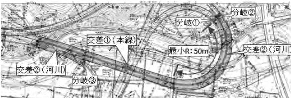
図-3 Eランプ橋平面図
