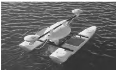
ラジコン型マルチビーム測深機
