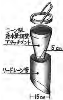
図-5 フリードレーンの仕組み (日本大学工学部OG南條さん作成)
