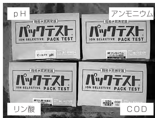
写真2. 水質試験(pH、リン酸、アンモニウム、COD)
