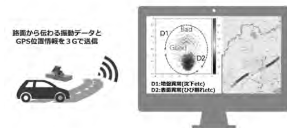
図1. 路面劣化診断技術の概要
