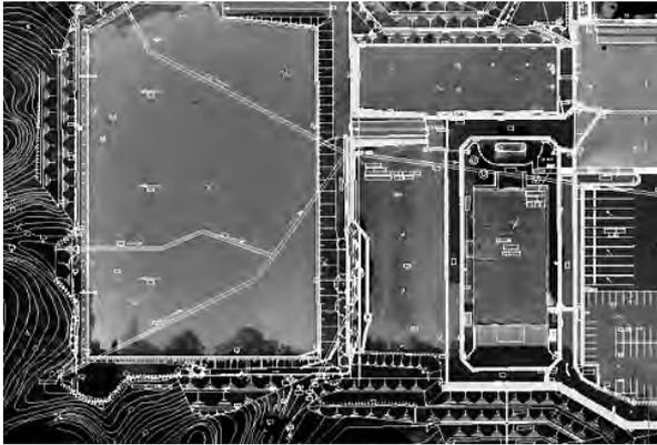
【図-7 2次元図とオルソ合成例（サッカー場）】
