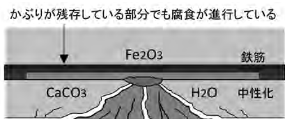
図-7 中性化による鉄筋の腐食膨張
