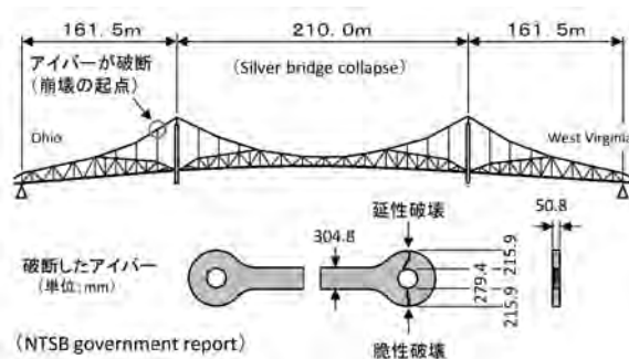
図－2 シルバー橋の落橋
