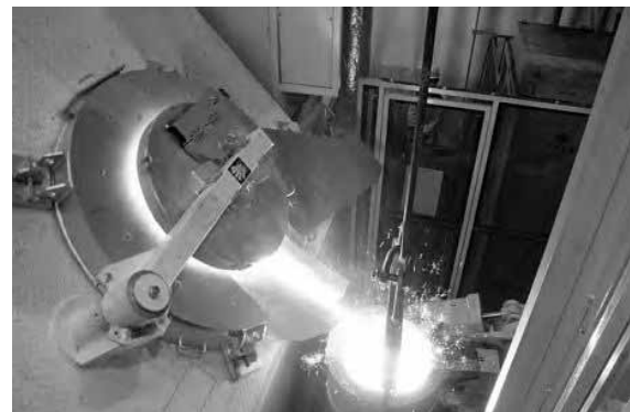
写真3. 電圧形誘導炉設備の出湯状況
