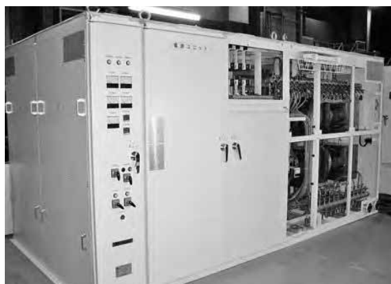
写真2. IGBT式電圧形インバータの正面 (600kW-500Hz)
